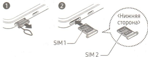
Вставьте штифт для извлечения в отверстие слота, чтобы извлечь лоток.
