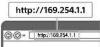
Можно вводить данный URL только в том случае, если ПК и основной блок соединены кабелем ЛВС.
