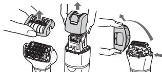
2. Очистите насадку для деликатной эпиляции [B], насадку для эпиляции [C D] и бритвенную насадку [F], используя щёточку для чистки [K].
